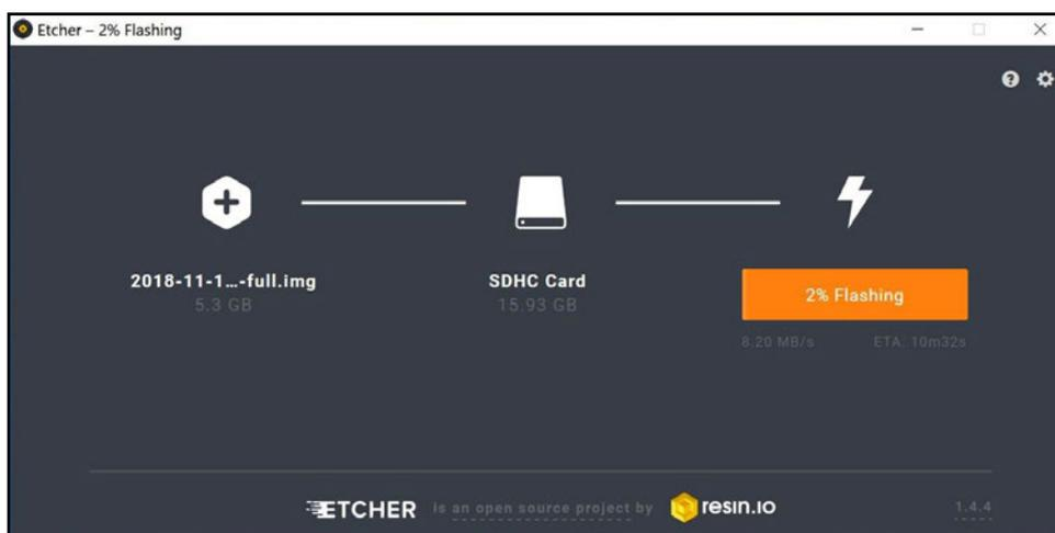
**Figura 6: Programmazione della scheda SD**
